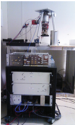
FIGURE : Prototype d'accéléromètre atomique compact développé au laboratoire LNE-SYRTE au cours de ma thèse. Au premier plan se trouve la source laser permettant la manipulation d'atomes froids. Au second plan se trouve la tête de capteur dans laquelle a lieu la mesure d'interférométrie atomique.
